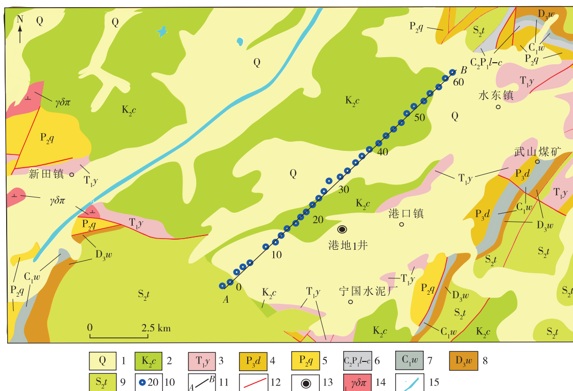
1.第四系;2.中白垩世赤山组;3.早三叠世殷坑组;4.晚二叠世大隆组;5.中二叠世栖霞组;6.晚泥盆世老虎洞组、晚石炭世黄龙组、早二叠世船山组互层;7.早石炭世王胡村组;8.晚泥盆世五通组;9.中志留世唐家坞组;10. MT 测点及编号;11. MT 测线 LAB;12. 实测断层;13. 钻井;14. 花岗闪长斑岩;15. 河流
