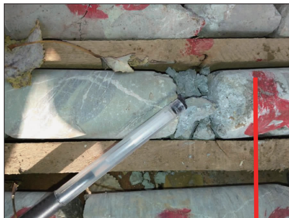
图 10 钻孔内岩体与围岩接触界面及褪色现象
