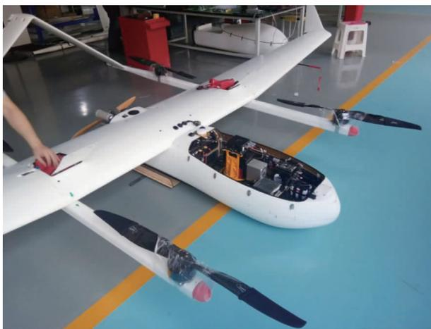
搭载于无人机的小型机载高光谱成像系统
