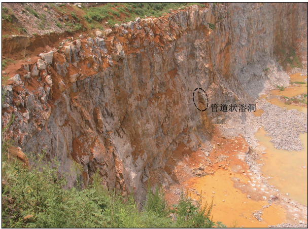
图 4 开采面管道状溶洞
