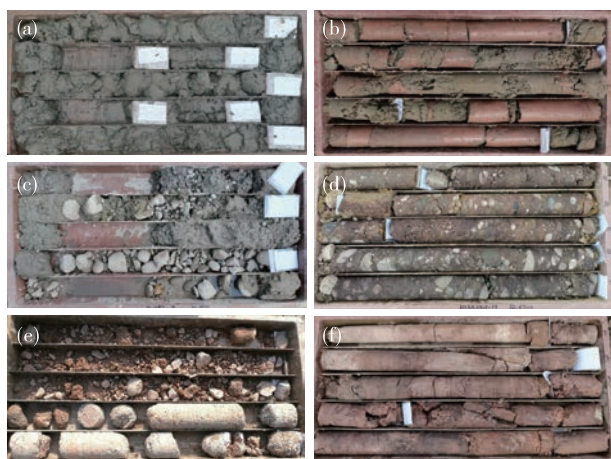
(a)和(b). I 地层(砂性土)岩心;(c)和(d). II 地层(卵砾石)岩心;(e)和(f). III 地层(破碎基岩)岩心
